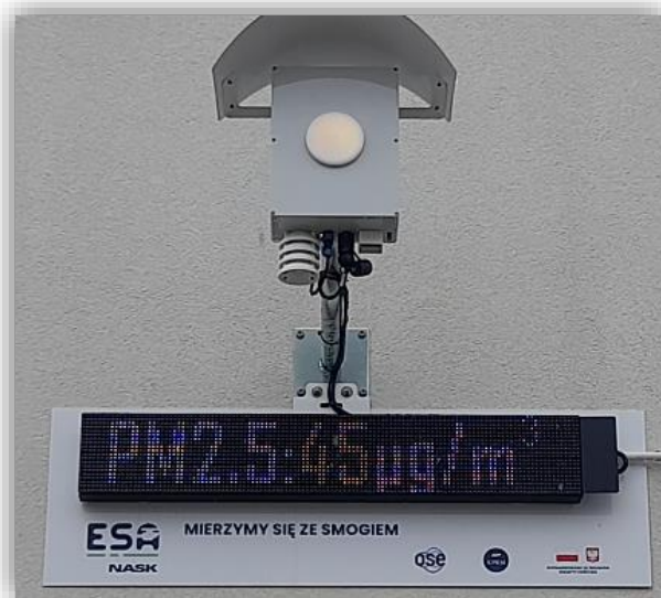
Czujnik z wyświetlaczem LED (SP1 w Górze)
